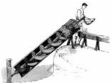
Ejemplo de Tornillo de Arquímedes.
