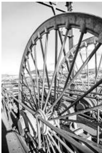
Poleas de 4,5m de diámetro situadas en la parte superior del castillete a más de 37 metros de altura.
