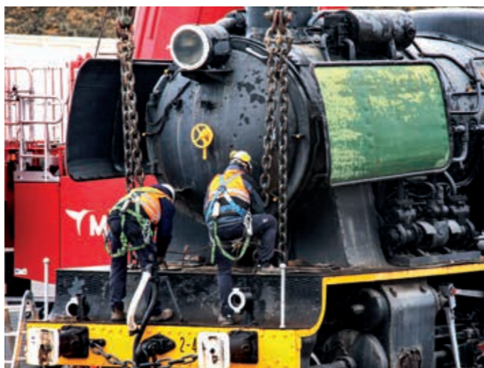
Operarios colocando los ganchos para poder levantar la locomotora.
