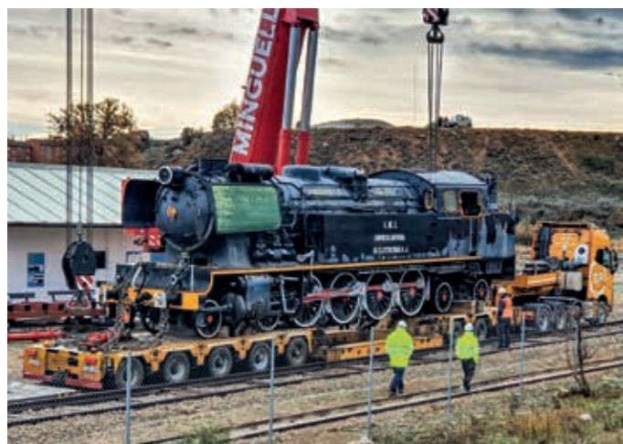
Delicado momento en el que con dos grúas de gran tonelaje se levanta la locomotora del camión para depositarla sobre los raíles preparados a tal fin en el museo minero.
