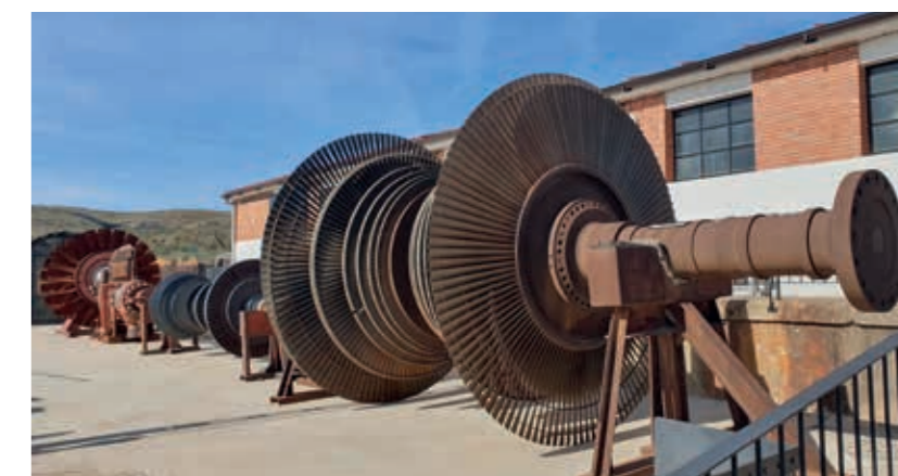
Dos rotores juntos, el de baja y el de alta presión.
